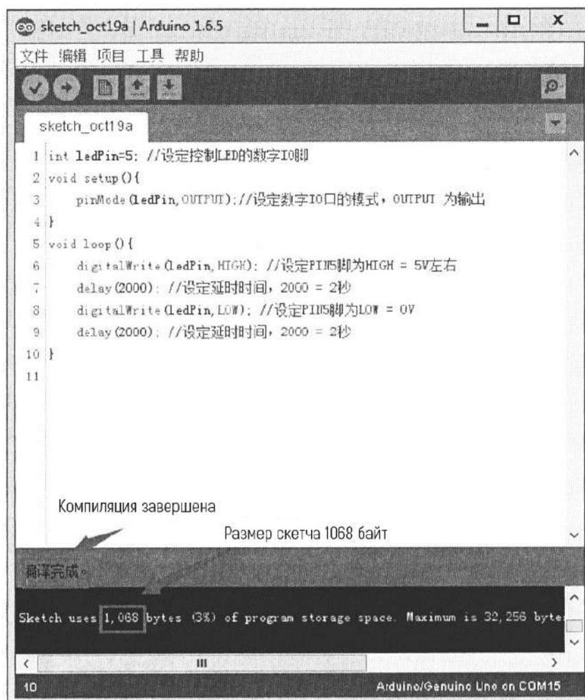
Чтобы загрузить скетч со скомпилированной программой в контроллер Arduino, нажмите кнопку загрузки.
