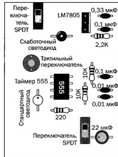
Рис. 4.149. Расположение и номиналы компонентов секции управления
