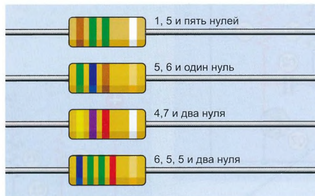
Рис. ЦВ-1.41. Четыре примера цветовой маркировки резистора
