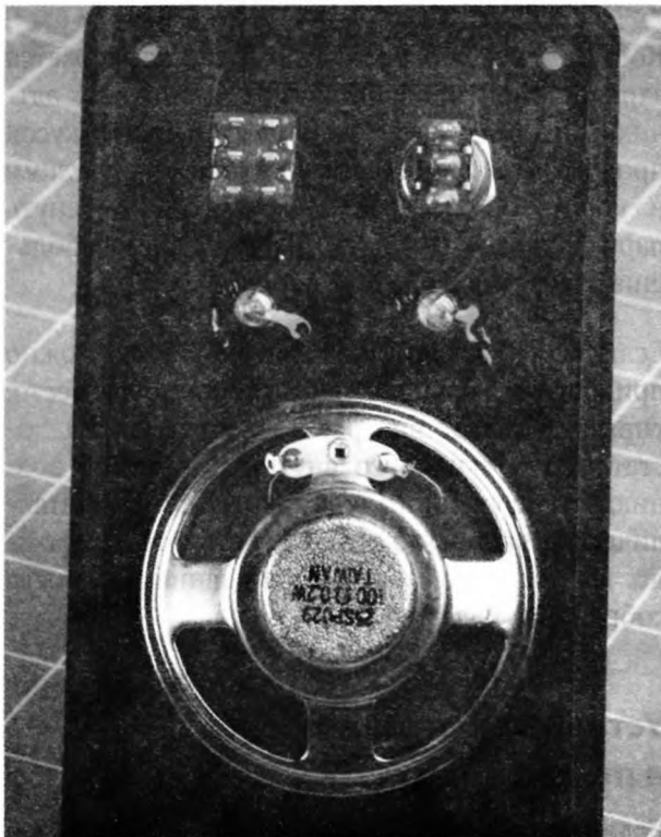
Рис. 4.55. Компоненты закреплены на передней панели (вид с обратной стороны). Динамик приклеен к корпусу. Для надежности немного клея нанесено на светодиоды
