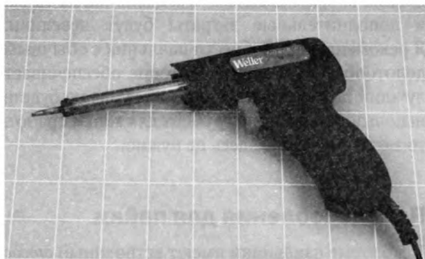
Рис. 3.4. Паяльник Weller Therma-Boost мощностью 30 Вт может быть полезен при работе с более толстыми проводами и крупными компонентами
