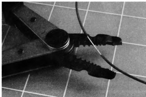
Рис. 5.66. Снятие изоляции на участке длиной около 1,5 см
