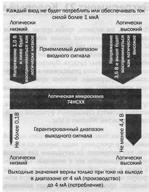
Рис. 4.98. Рекомендуемые диапазоны уровней напряжения для логических микросхем
