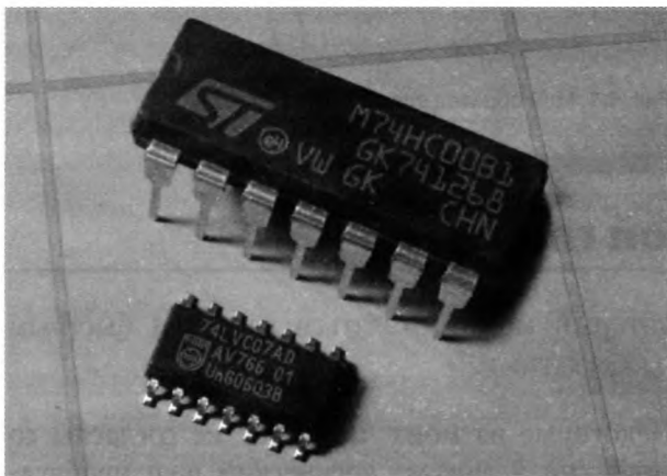
Рис. 4.2. Микросхема для установки в монтажные отверстия (вверху) и микросхема для поверхностного монтажа (внизу)
