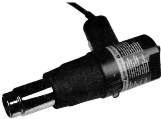
Рис. 3.10. Термофен для усадки трубки позволяет создать плотное изолирующее покрытие вокруг оголенного провода
