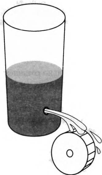
Рис. 1.64. Если колесо извлекает энергию из потока воды, поток выполняет какую-то работу, которая может быть измерена в ваттах за определенный период времени
