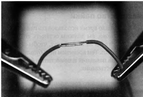
Рис. 3.34. Шаг 1: выровняйте провода
