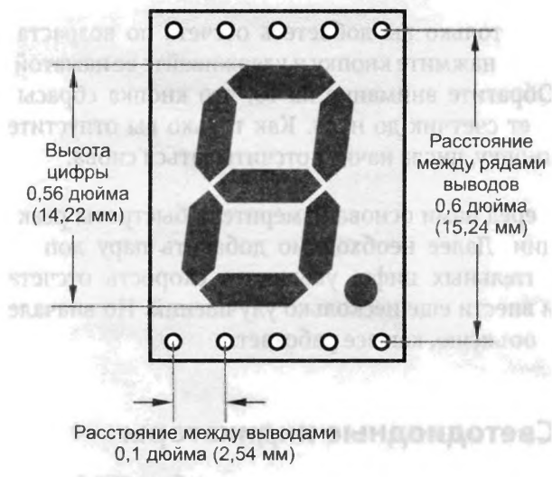
Рис. 4.63. Размеры и расположение выводов стандартного семисегментного светодиодного индикатора с высотой цифры 14,2 мм
