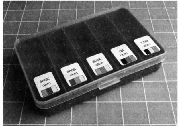
Рис. 5.5. Чтобы убедиться в том, что резистор не будет помещен в неправильное отделение, нанесите на каждую наклейку цветовой код
