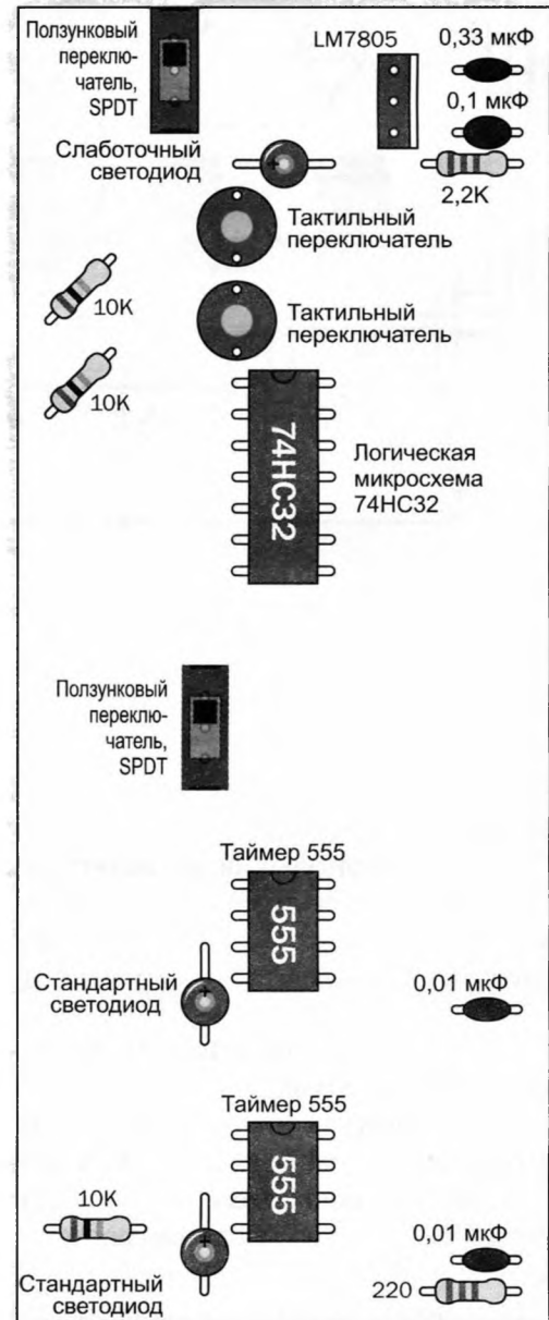
Рис. 4.121. Номиналы и расположение компонентов на макетной плате
