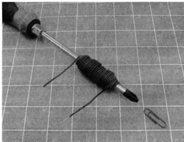
Рис. 5.9. Этот простейший электромагнит способен притянуть скрепку
