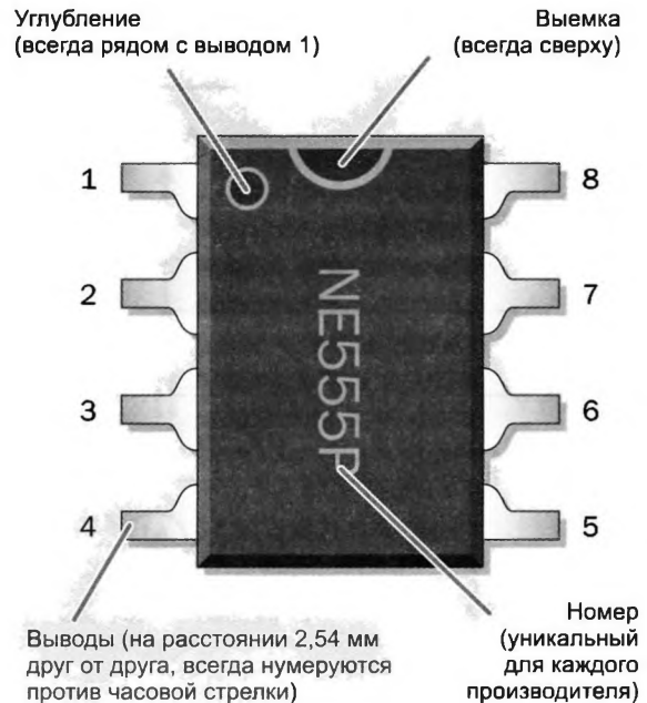
Рис. 4.9. Вариант корпуса микросхемы с восьмью выводами. Практически все микросхемы имеют полукруглую выемку сверху, но не везде есть метка возле первого вывода
