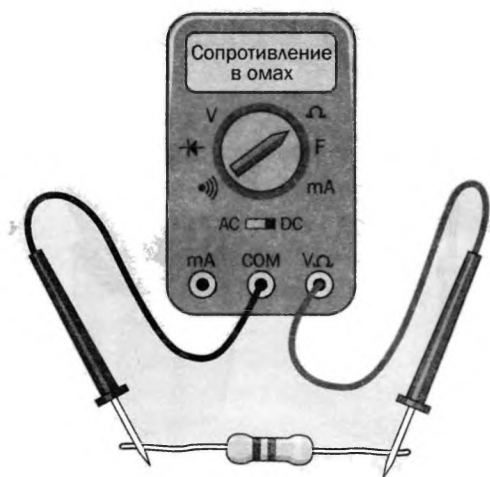
Рис. 1.43. Определение номинала резистора
