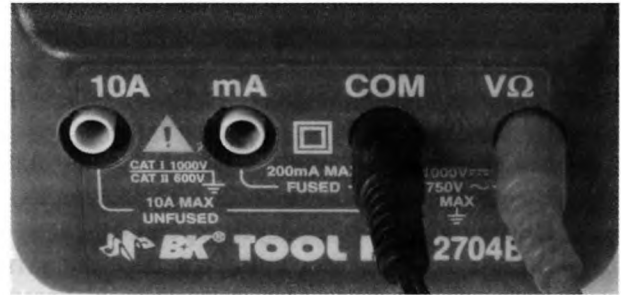
Рис. 1.18. Обратите внимание на маркировку гнезд этого мультиметра
