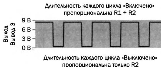
Рис. 4.26. При стандартном включении таймера 555 в режиме автоколебаний импульсы всегда длиннее, чем паузы между ними
