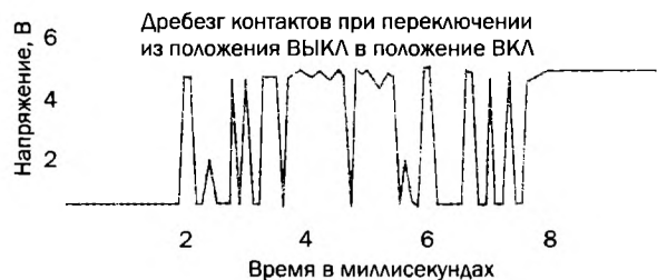
Рис. 4.123. Колебания, созданные вибрацией контактов при замыкании переключателя (Взято из технического паспорта корпорации Maxim Integrated.)
