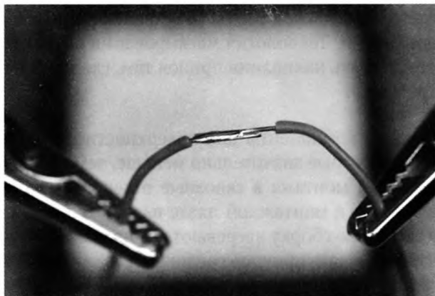
Рис. 3.38. Шаг 5: готовое соединение блестит, припой равномерно распределен вдоль проводов
