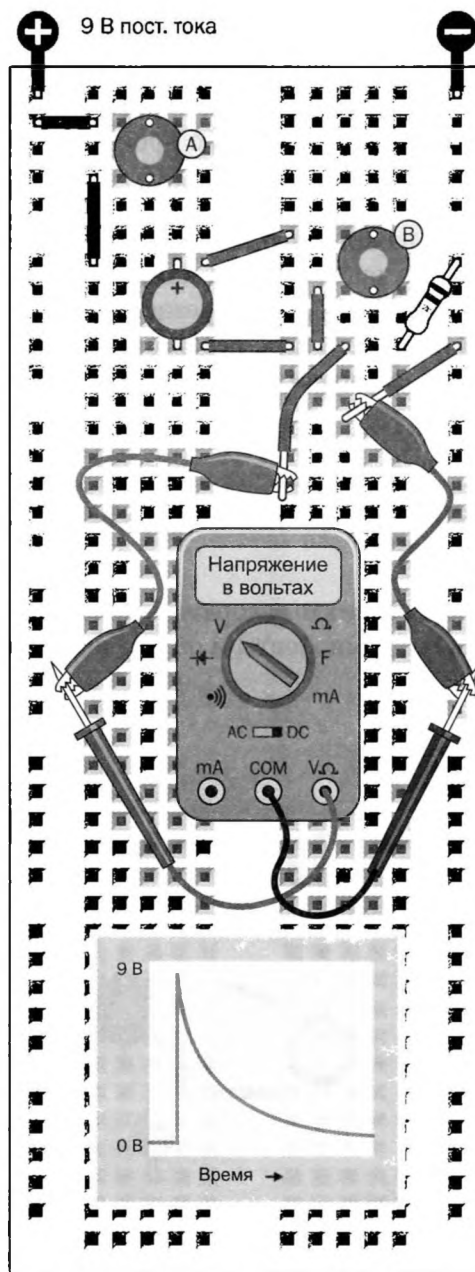
Рис. 2.85. Вместо светодиода с резистором в этой установке включен мультиметр
