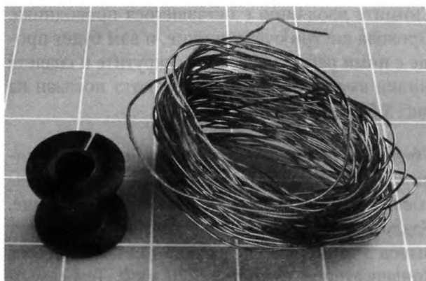
Рис. 5.56. Катушка индуктивности для разделительного аудиофильтра состоит лишь из пластмассового каркаса и обмотки
