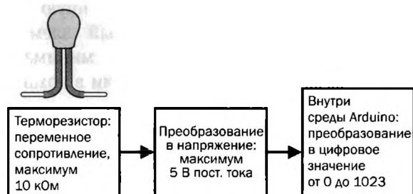
Рис. 5.86. Упрощенная последовательность обработки сигнала от терморезистора
