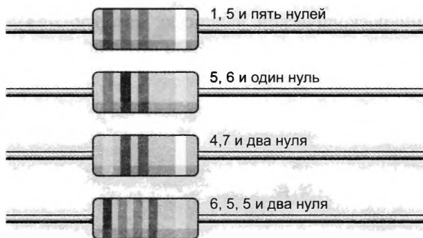
Рис. ЦВ-1.41. Четыре примера цветовой маркировки резистора
